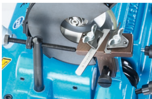
Coltellino superiore con perni di fissaggio e coltellino inferiore
